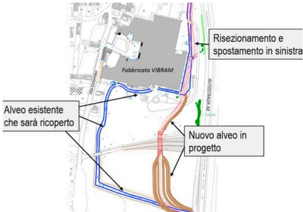
Il progetto di Vibram nasce dalla **necessità di risolvere una situazione di elevata insufficienza idraulica del Torrente Arno** nel tratto tra la fabbrica e l'Autostrada A8 che, come molti ricorderanno, è stato causa di frequenti allagamenti (L'ultimo in ordine temporale **era stato quello dell'agosto del 2014**).
